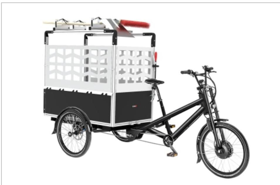
De nombreux détails malins : fermoir à serrage ajustable pour les volets arrière et latéraux, parois latérales amovibles aux innombrables possibilités de fixation d'accessoires.
