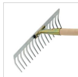
**Profi-Planierrechen (gehärtet, verstellbar)** Robuster, gerader Planierrechen mit patentierter Verstellbarkeit des Kopfwinkels für den professionellen Einsatz. Stieldülle, gehärteter, verzinkter Stahl, Materialstärke Kopf 4 mm, VE 10
